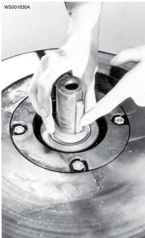
2. Coloque a anilha no parafuso do impulsor.
