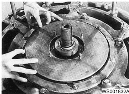
3. Instale o difusor superior voltando a montar pela ordem inversa da desmontagem.
