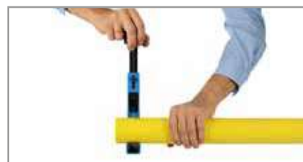
3. Cortar o tubo de forma totalmente reta.
