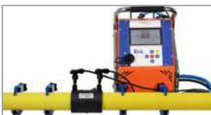
11. Início da soldadura.
